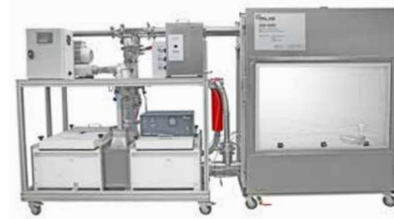
Wir bieten kontrollierte Beaufschlagung und Testung in einer definierten Prüfluft. Aus Suspensionen oder Feststoffen werden anorganische Stäube, Mikroorganismen oder deren Bestandteile kontrolliert und gleichmäßig und über einen langen Zeitraum konstant in das System abgegeben. Es können mehrere Geräte/Prüflinge gleichzeitig ins System eingebracht und parallel getestet werden.
